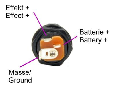
Die Belegung der DC Buchse ist innen -, außen +. Die meisten Effektgeräte haben eine "negative ground" Schaltung, die Masse ist negativ. Effekte mit Germanium Transistoren haben aber meistens "positive ground", Masse ist da positiv. Das ändert aber nichts an der Belegung der DC-Buchse. Da bleibt es bei innen- und außen +. Da wird nur die Spannung auf der Platine anders angeschlossen.
