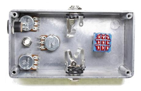
Damit ist die mechanische Montage abgeschlossen, jetzt kommt es zur großen Union von Elektrik und Mechanik.
