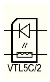
Die oberen beiden Eingänge stellen die LED dar, unten der Widerstand, der vomLicht der LED beeinflusst wird.
