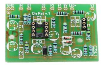
Achtet beim IC-Sockel darauf, dass die Kerbe des Sockels (oben) mit der Markierung auf der Platine übereinstimmt.
