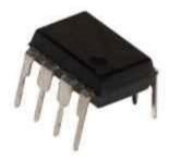
ICs sind empfindlich gegen zu langem löten, deswegen werden sie immer in einen passenden Sockel gesteckt. Dieser hat ebenfalls eine Einkerbung, welche die Seite markiert, auf die Pin 1 gehört. Diese Markierung findet sich auch auf der Platine aufgedruckt.
